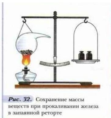
Рис. 32. Сохранение массы веществ при прокаливании железа в запаянной реторте
